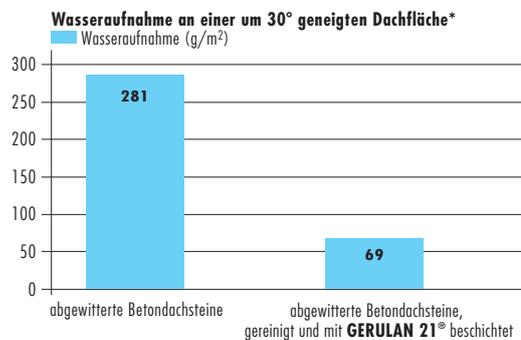
\* gravimetrisch berechnet über die Differenz aus abgelaufener Wassermenge zur Ausgangsmenge von 1l Wasser; gleichmäßig aufgebracht innerhalb einer Minute auf eine 30° geneigte Prüffläche von 0,16 m<sup>2</sup>; gemessen nach 1 Minute Abtropfzeit.
